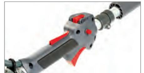
Das "AlwaysOn" Ein/Aus-System kehrt nach jedem Abschalten automatisch in die Startposition zurück.
