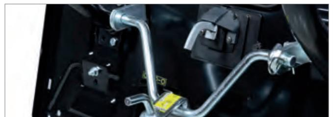
Die serienmäßige Anhängerkupplung macht die Maschine noch vielseitiger und ermöglicht das Ziehen eines Anhängers oder einer Rasenwalze.
