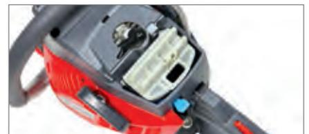
Nylonfilter: längere Betriebszeit zwischen den Filterreinigungen dank der großen Filterfläche.
