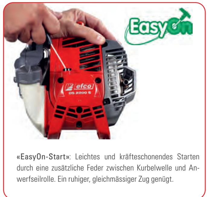
«EasyOn-Start»: Leichtes und kräfteschonendes Starten durch eine zusätzliche Feder zwischen Kurbelwelle und Anwerfseilrolle. Ein ruhiger, gleichmässiger Zug genügt.
