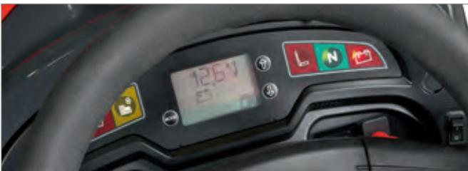
Elektronisches LCD-Display, das eine schnelle und unmittelbare Anzeige der wichtigsten Informationen des Gartentraktors ermöglicht, einschließlich Betriebsstunden, Batteriespannung und Kraftstoffstand.
