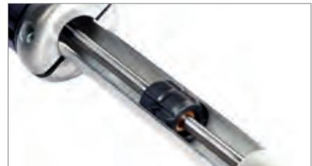
Starre Antriebswelle, Ø 8 mm: hohe Zuverlässigkeit dank der starren Antriebswelle, die auf 6 selbstschmierenden Buchsen läuft.
