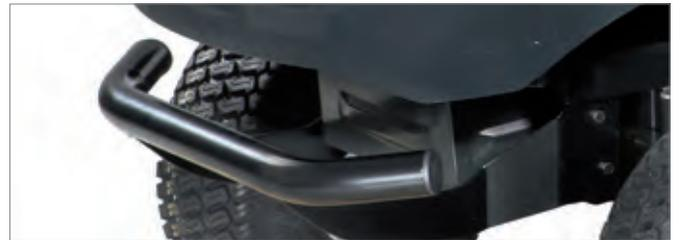
Großzügig dimensionierte Frontstoßstange aus Stahl für hohe Festigkeit und Widerstand bei bei einem ungewollten Aufprall.
