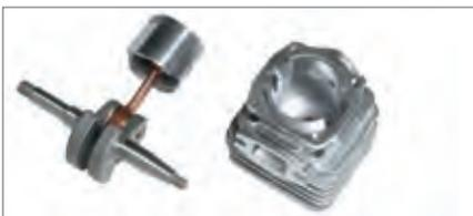
Kolben mit 2 Ringen, vernickelter Druckguss Zylinder, geschmiedete Pleuelstange und Kurbelwelle: alles Merkmale, die den Motor extrem robust und langlebig machen.
