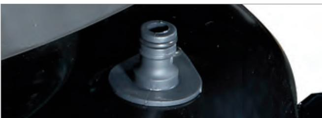
Der Schnellanschluss "Deck Wash System" am Mähdeck ermöglicht es Wasser in das Mähdeck zu leiten, um das Schneidwerk schnell und einfach zu reinigen.
